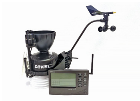
Основные метеорологические характеристики Автономный регистратор VANTAGE Pro2
