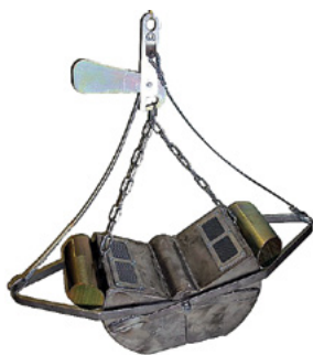
Отбор проб донных грунтов Дночерпатель бентосный
