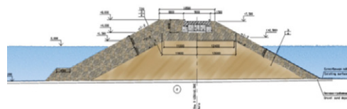
Ouvrages de défense la prise d'eau de mer pour la centrale nucléaire de Kudankulam (République de l'Inde)
